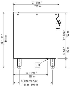
El = Electrical inlet (power) **EQ** = Equipotential screw
